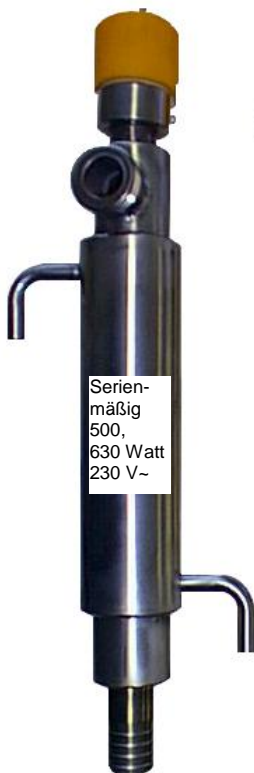
Durchlauferhitzer aus Edelstahl oder Titan mit Schlauchanschluss Ø 25, Gewindeanschluss G 1 ¼" und Flanschanschluss (Flansch-Ø 120mm, 6 Bohrungen Ø 7mm, Teilkreis 105mm lieferbar).
