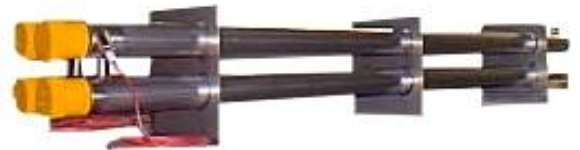
Durchlauferhitzer aus Edelstahl oder Titan mit Schlauchanschluss oder Gewindeanschluss G 1", 1 ¼", 1 ½". Mit Pt 100 Temperaturfühler für Temperaturregler, Temperaturbegrenzer. Heizleistung pro Heizrohr 10 kW, Gesamtleistung 40 kW 3x400V
