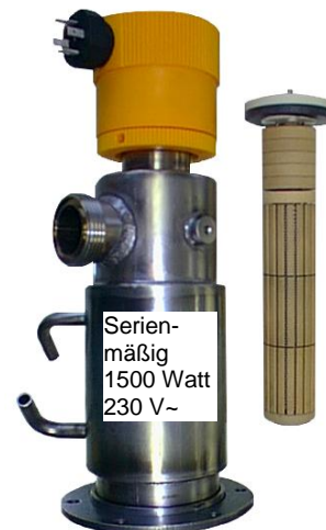
Durchlauferhitzer aus Edelstahl oder Titan mit Schlauchanschluss Ø 25, Gewindeanschluss G 1 ¼" und Flanschanschluss (Flansch-Ø 120mm, 6 Bohrungen Ø 7mm, Teilkreis 105mm lieferbar).
