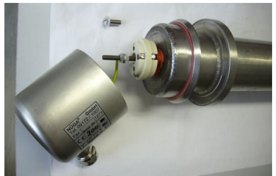
Flansch-Heizkörper: Mit Rundflansch Ø 120mm, der Heizeinsatz ist gekapselt und schlagfeste eingebaut. mit wasserdichter Edelstahlabdeckkappe Ø 80mm. Aus Edelstahl, Stahl und Titan.
