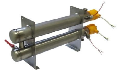
Durchlauferhitzer aus Edelstahl oder Titan mit Schlauchanschluss oder Gewindeanschluss G 1", 1 ¼", 1 ½" mit Pt 100 Temperaturfühler für Temperaturregler, Temperaturbegrenzer.
