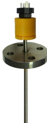
Temperaturfühler mit Rundflansch Ø 100mm, mit einge- bautem Pt 100, PTC-Temperaturregler mit Hirschmann Stecker Lieferbar aus Edelstahl, Stahl, Titan und PP.
