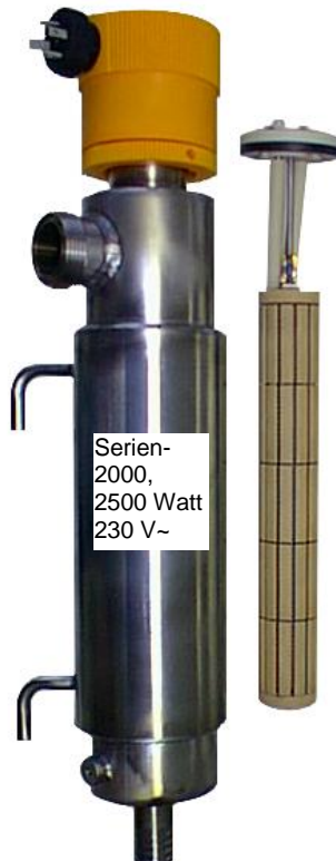
Durchlauferhitzer aus Edelstahl oder Titan mit Schlauchanschluss Ø 25, Gewindeanschluss G 1 ¼" und Flanschanschluss (Flansch-Ø 120mm, 6 Bohrungen Ø 7mm, Teilkreis 105mm lieferbar).
